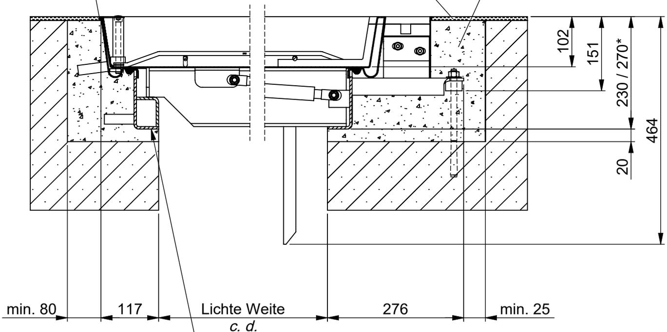
Der Rahmen muss komplett aufliegen um ev. Beschädigungen der eingebauten Schachtabdeckung zu vermeiden
